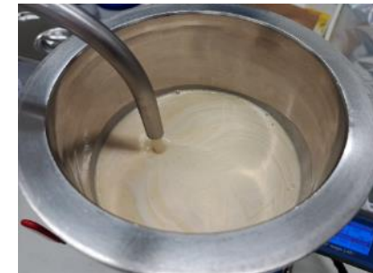
Kolloidmühle zur Homogenisation
