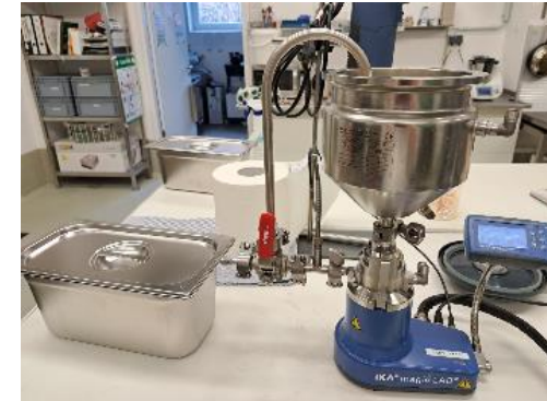
Kolloidmühle zur Homogenisation
