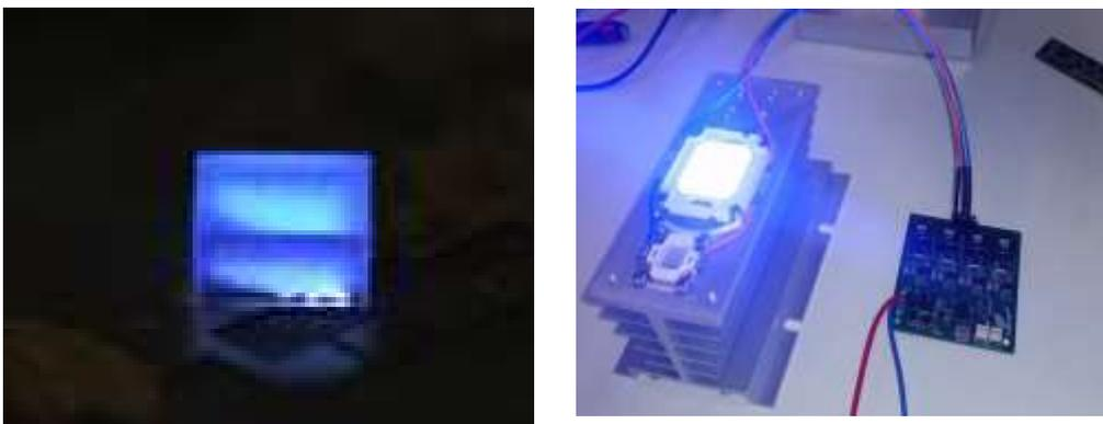
Bild 5: UV-LED einzeln (1 mm Kantenlänge) und viele zu einem 10 x 10 cm Strahler zusammengefasste LEDs mit Kühlung und Ansteuerung [Nie]
