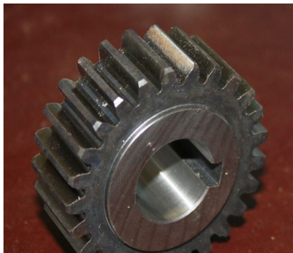
Blick auf die präparierte Zahnradflanke (braun -"12 Uhr")
